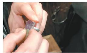
④王师傅在旁边同时打磨好“四个银爪”，量好记者的手指围，就用备好的银条做戒圈，用镊子小心地将“四个银爪”和戒圈与戒托组装拼接。
