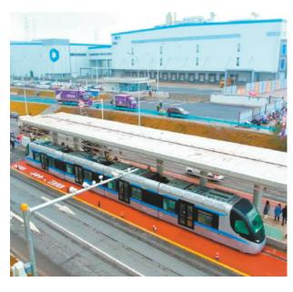
1月3日,重庆铜梁,导轨电车试验线开始进行单体调试及车 辆型式试验。导轨电车作为一种公共交通,最高时速可达到80公 里,全长10.494公里,共设黄家岩、祝英村、实验中学、金龙一路、 中兴路5个车站。
