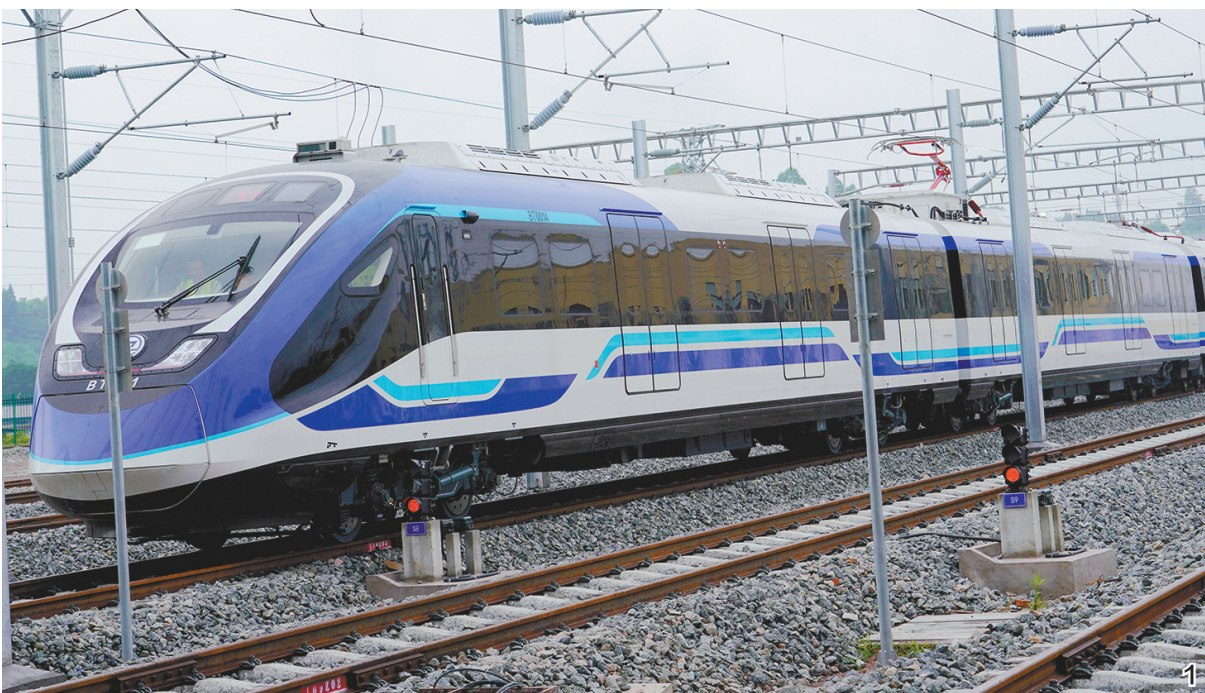
图1:市域铁路璧铜线进行接触网热滑试验
