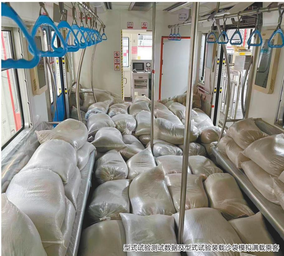
型式试验测试数据及型式试验装载沙袋模拟满载乘客
